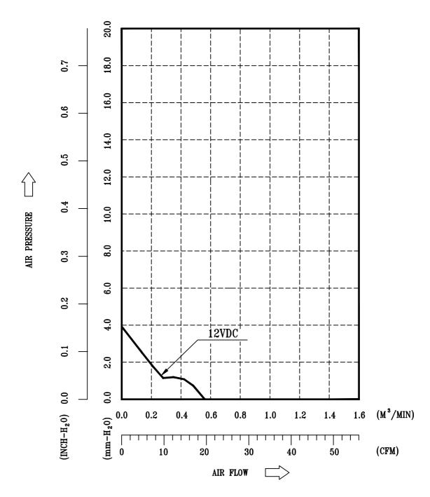
\* TEST CONDITION: INPUT VOLTAGE ---- OPERATION VOLTAGE TEMPERATURE ---- ROOM TEMPERATURE HUMIDITY ----- 65%RH
