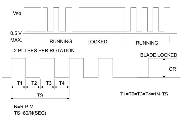
\*VOLTAGE LEVEL AFTER BLADE LOCKED
