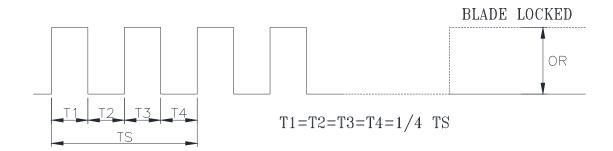
N=R.P.M TS=60/N(SEC) \*VOLTAGE LEVEL AFTER BLADE LOCKED \*4 POLES
