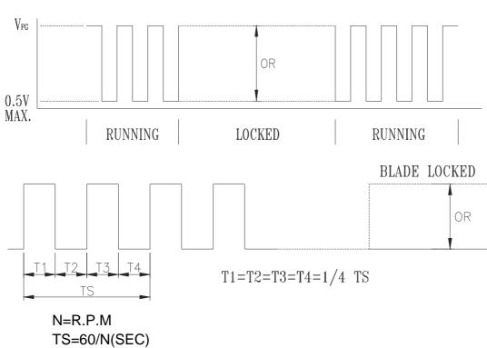
\*VOLTAGE LEVEL AFTER BLADE LOCKED \*4 POLES
