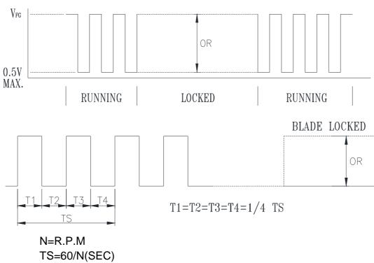
\*VOLTAGE LEVEL AFTER BLADE LOCKED
