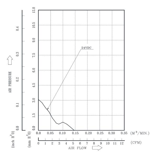
\*TEST CONDITION: INPUT VOLTAGE-----OPERATION VOLTAGE TEMPERATURE-----ROOM TEMPERATURE HUMIDITY-----65%RH DELTA MODEL: EFB0424LD-CP5
