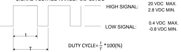
\*THE FREQUENCY FOR CONTROL SIGNAL OF THE FAN SHALL BE ABLE TO ACCEPT A 600HZ~30KHZ.
