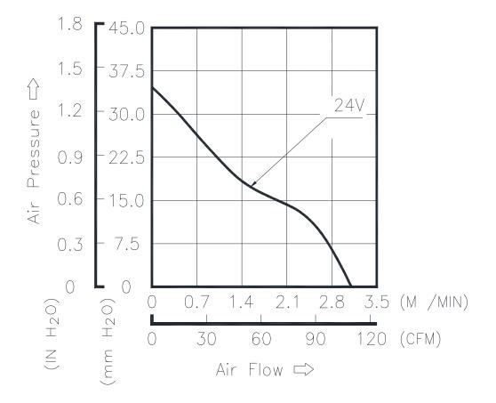
\*TEST CONDITION: INPUT VOLTAGE-----OPERATION VOLTAGE TEMPERATURE-----ROOM TEMPERATURE HUMIDITY-----65%RH
