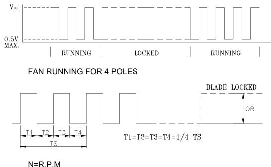
TS=60/N(SEC) \*VOLTAGE LEVEL AFTER BLADE LOCKED \*4 POLES
