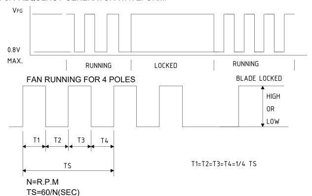
\*VFG IS ALWAYS HIGH OR LOW LEVEL AFTER BLADE LOCKED \*4 POLES
