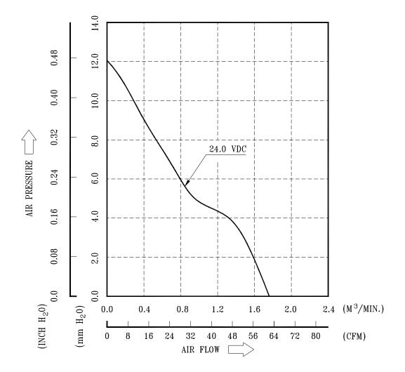
\*TEST CONDITION: INPUT VOLTAGE-----OPERATION VOLTAGE TEMPERATURE-----ROOM TEMPERATURE HUMIDITY-----65%RH
