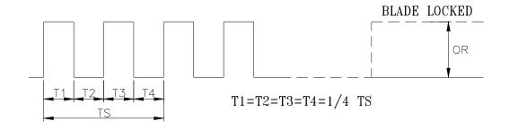
N=R.P.M TS=60/N(SEC) \*VOLTAGE LEVEL AFTER BLADE LOCKED \*4 POLES
