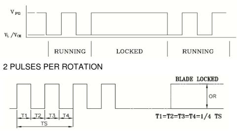
N=R.P.M TS=60/N(SEC) \*VOLTAGE LEVEL AFTER BLADE LOCKED \*2 PULSES
